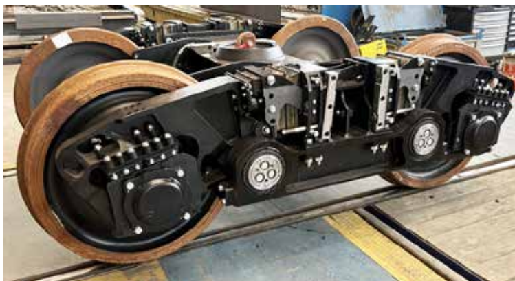
Podvozok NP-S s kompaktnou brzdou – 3D model a reálne vyrobený podvozok
