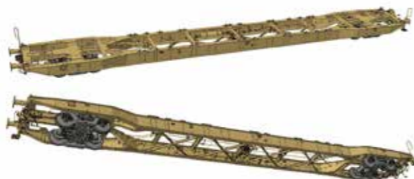
Vozeň Sggnss 80' pre 160km/h s podvozkami RC25NT
